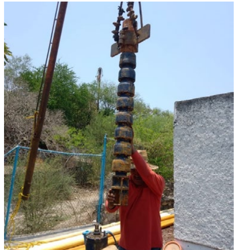
▲ Entre la falta de agua y la manipulación irresponsable de la ciudadanía, varios equipos de bombeo en pozos de Jojutla han sido dañados. Foto: Hugo Barberi.
